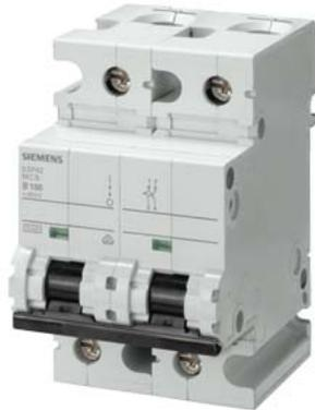
Interruttore magnetotermico 400V 10 kA, a 2 poli, D, 100A, P=70mm
