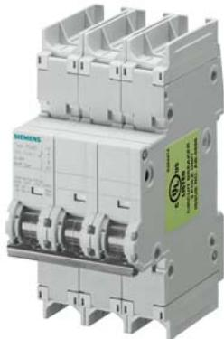
interruttore magnetotermico 240V 14kA, a 3 poli, D, 10A, P=70mm secondo UL 489
