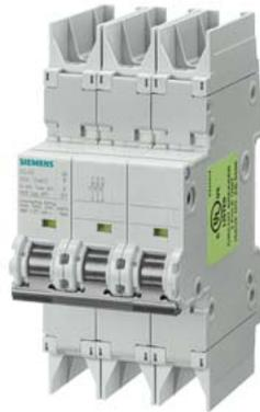
interruttore magnetotermico 10kA, a 3 poli, D, 2A secondo UL 489-480Y/277V
