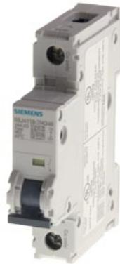
interruttore magnetotermico 240V 14kA, a 1 polo, D, 5A, P=70mm secondo UL 489, stessa polarità
