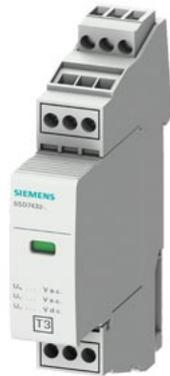
SPD tipo 3,  $U_n=240$  V AC/DC 264 V AC/240 V DC,  $U_{oc}=6$  kV, a 2 poli, con segnalazione a distanza, larghezza 17,7 mm
