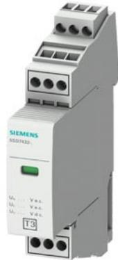
SPD tipo 3,  $U_n=120\text{ V AC}/150\text{ V DC DC}$ ,  $U_c=\text{AC/DC } 150\text{ V}$ ,  $U_{oc}=2\text{ kV}$ , a 2 poli, con segnalazione a distanza, larghezza 17,7 mm
