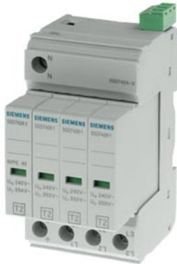
Scaricatore di sovratensioni T2, Un AC 240/400 V, Uc AC 350/264 V, moduli di protezione inseribili, circuito 3+1 (TN-S, TT), larghezza 49,2 mm
