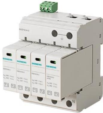
scaricatore di sovratensione di origine atmosferica T1/T2, UN 240/400V, UC AC 335/264V, moduli di protezione inseribili, 3+1 circuito (TN-S, TT), larghezza 72mm con segnalazione a distanza
