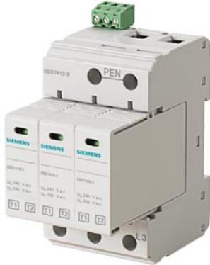
scaricatore di sovratensione di origine atmosferica T1/T2, UN 240/400V, UC AC 335V, moduli di protezione inseribili, 3+0 circuito (TN-C), larghezza 54mm con segnalazione a distanza
