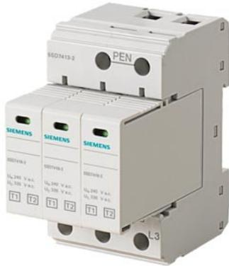
scaricatore di sovratensione di origine atmosferica T1/T2, UN 240/400V, UC AC 335V, moduli di protezione inseribili, 3+0 circuito (TN-C), larghezza 54mm
