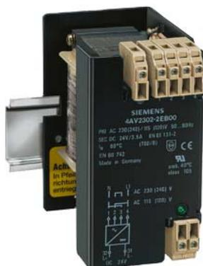
Alimentazione; fasi: 1; PN (kW): 0,084; Upri (V): 230 ... 115; Usec (V DC): 24; Isec (A DC): 3,5/4,2 (60/40 CEL); F (Hz): 50 ... 60; gruppo di collegamento/avvolgimento di schermatura: IIO /O; Classe di protezione: I; classe TA/ISO: 60/B; W (%): 5; IP00; collegamento: morsetti a vite/attacchi a spina piatta; collegamento; montaggio: guida DIN EN 61558-2-6, EN 61131-2 >Trasformatore di sicurezza<
