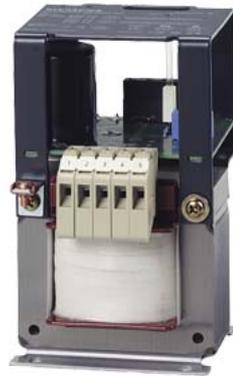
Alimentazione; fasi: 1; PN (kW): 0,12; Upri (V): 400 ... 230+/-15; Usec (V DC): 24; Isec (A DC): 5/6 (60/40 CEL); F (Hz): 50 ... 60; gruppo di collegamento/avvolgimento di schermatura: Ii0 /0; Classe di protezione: I; classe TA/ISO: 60/B; W (%): 5; IP00; collegamento: morsetti a vite/attacchi a spina piatta; collegamento; montaggio: viti; EN 61558-2-6, EN 61131-2 >Trasformatore di sicurezza<
