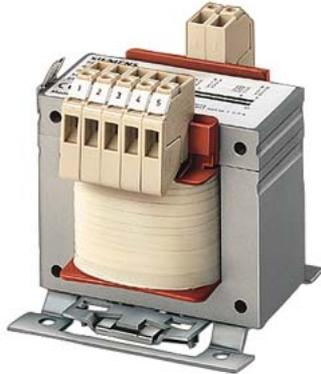
Trasformatore SITAS; fasi: 1; PN/PN (S6) (kVA): 0,25 /0,85; Upri (V): 400 ... 230+/-15; Usec (V): 24; Isec (A): 10,4; F (Hz): 50 ... 60; gruppo di collegamento/avvolgimento di schermatura: II0 /0; classe TA/ISO: 40/B; IP00; collegamento: morsetti a vite/attacchi a spina piatta; collegamento; montaggio: viti / guida DIN; EN 61558-2-2, -2-6 >UL/CSA-recognized< >Trasformatore di comando< >Trasformatore di sicurezza<
