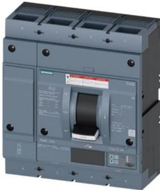
interruttore automatico 3VA6 UL Frame 1000 classe del potere di interruzione C 100 kA con 480 V a 4 poli, protezione impianto ETU856, LSI,  $I_n=1000$  A protezione da sovraccarico  $I_r=400$  A ... 1000 A protezione da cortocircuito  $I_{sd}=0,6$  ...  $10 \times I_n$ ,  $I_i=1,5$  ...  $10 \times I_n$  protezione del conduttore di neutro impostabile (OFF, fino al 160 %) allarme di guasto verso terra segnalazione tramite EFB300 o COM attacchi piatti a vite
