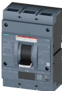
interruttore automatico 3VA6 UL Frame 1000 classe del potere di interruzione C 100 kA con 480 V a 3 poli, protezione impianto ETU856, LSI,  $I_n=1000$  A protezione da sovraccarico  $I_r=400$  A ... 1000 A protezione da cortocircuito  $I_{sd}=0,6$  ...  $10 \times I_n$ ,  $I_i=1,5$  ...  $10 \times I_n$  protezione del conduttore di neutro opzionale con CT est. fino a 160% allarme di guasto verso terra segnalazione tramite EFB300 o COM
