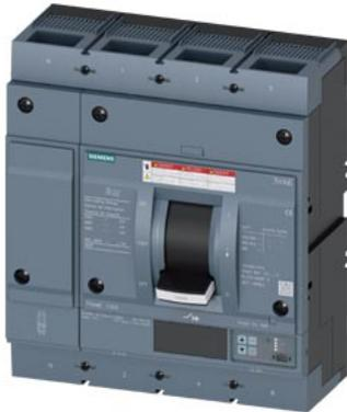
interruttore automatico 3VA6 UL Frame 1000 classe del potere di interruzione C 100 kA con 480 V a 4 poli, protezione impianto ETU556, LSI,  $I_n=1000$  A protezione da sovraccarico  $I_r=400$  A ... 1000 A protezione da cortocircuito  $I_{sd}=0,6$  ...  $10 \times I_n$ ,  $I_i=1,5$  ...  $10 \times I_n$  protezione del conduttore di neutro impostabile (OFF, fino al 160 %) allarme di guasto verso terra segnalazione tramite EFB300 o COM attacchi piatti a vite
