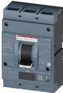
interruttore automatico 3VA6 UL Frame 1000 classe del potere di interruzione C 100 kA con 480 V a 3 poli, protezione impianto ETU560, LSIG, In=1000 A protezione da sovraccarico Ir=400 A ... 1000 A protezione da cortocircuito I<sub>sd</sub>=0,6 ... 10x I<sub>n</sub>, I<sub>i</sub>=1,5 ... 10x I<sub>n</sub> protezione del conduttore di neutro opzionale con CT est. fino a 160% protezione da guasto verso terra I<sub>g</sub>=0,2 ... 1 x I<sub>n</sub>, t<sub>g</sub>=0,05 ... 0,8s
