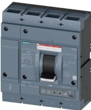
interruttore automatico 3VA6 UL Frame 1000 classe del potere di interruzione C 100 kA con 480 V a 4 poli, protezione impianto ETU330, LIG, In=1000 A protezione da sovraccarico Ir=400 A ... 1000 A protezione da cortocircuito I<sub>c</sub>=1,5 ... 10 x In protezione del conduttore di neutro impostabile (OFF, 50 %, 100 %) protezione da guasto verso terra Ig=0,2 ... 1 x In, tg=0,1/0,3s attacchi piatti a vite
