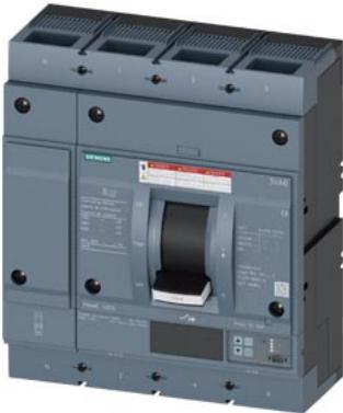
interruttore automatico 3VA6 UL Frame 1000 classe del potere di interruzione H 65 kA con 480 V a 4 poli, protezione impianto ETU856, LSI, In=1000 A protezione da sovraccarico Ir=400 A ... 1000 A protezione da cortocircuito Isd=0,6 ... 10x In, Ii=1,5 ... 10x In protezione del conduttore di neutro impostabile (OFF, fino al 160 %) allarme di guasto verso terra segnalazione tramite EFB300 o COM attacchi piatti a vite
