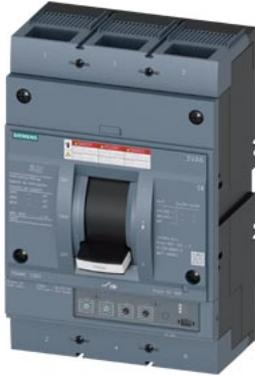
interruttore automatico 3VA6 UL Frame 1000 classe del potere di interruzione H 65 kA con 480 V a 3 poli, protezione impianto ETU330, LIG,  $I_n=1000$  A protezione da sovraccarico  $I_r=400$  A ... 1000 A protezione da cortocircuito  $I_i=1,5$  ...  $10 \times I_n$  protezione da guasto verso terra  $I_g=0,2$  ...  $1 \times I_n$ ,  $t_g=0,1/0,3s$  attacchi piatti a vite
