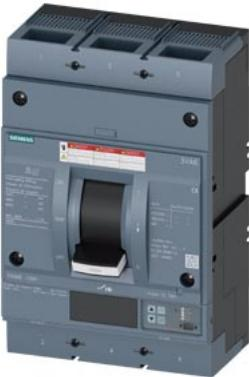
interruttore automatico 3VA6 UL Frame 1000 classe del potere di interruzione M 35 kA con 480 V a 3 poli, protezione impianto ETU856, LSI,  $I_{n}=1000$  A protezione da sovraccarico  $I_{r}=400$  A ... 1000 A protezione da cortocircuito  $I_{sd}=0,6$  ... 10x  $I_n$ ,  $I_{i}=1,5$  ... 10x  $I_n$  protezione del conduttore di neutro opzionale con CT est. fino a 160% allarme di guasto verso terra segnalazione tramite EFB300 o COM
