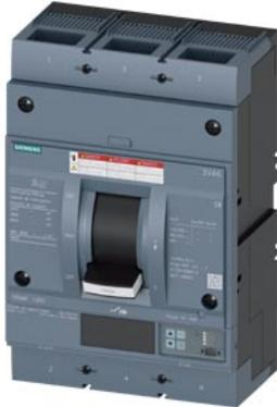
interruttore automatico 3VA6 UL Frame 1000 classe del potere di interruzione M 35 kA con 480 V a 3 poli, protezione impianto ETU556, LSI,  $I_n=1000$  A protezione da sovraccarico  $I_r=400$  A ... 1000 A protezione da cortocircuito  $I_{sd}=0,6$  ...  $10 \times I_n$ ,  $I_i=1,5$  ...  $10 \times I_n$  protezione del conduttore di neutro opzionale con CT est. fino a 160% allarme di guasto verso terra segnalazione tramite EFB300 o COM
