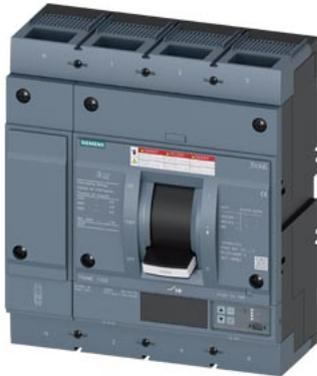
interruttore automatico 3VA6 UL Frame 1000 classe del potere di interruzione M 35 kA con 480 V a 4 poli, protezione impianto ETU550, LSI,  $I_n=1000$  A protezione da sovraccarico  $I_r=400$  A ... 1000 A protezione da cortocircuito  $I_{sd}=0,6$  ...  $10 \times I_n$ ,  $I_i=1,5$  ...  $10 \times I_n$  protezione del conduttore di neutro impostabile (OFF, fino al 160 %) attacchi piatti a vite
