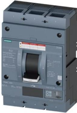
interruttore automatico 3VA6 UL Frame 1000 classe del potere di interruzione M 35 kA con 480 V a 3 poli, protezione impianto ETU550, LSI,  $I_n=1000$  A protezione da sovraccarico  $I_r=400$  A ... 1000 A protezione da cortocircuito  $I_{sd}=0,6$  ...  $10 \times I_n$ ,  $I_i=1,5$  ...  $10 \times I_n$  protezione del conduttore di neutro opzionale con CT est. fino a 160% attacchi piatti a vite
