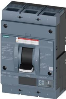
interruttore automatico 3VA6 UL frame 800 classe del potere di interruzione C 100 kA con 480 V a 3 poli, protezione impianto ETU860, LSIG, In=800 A protezione da sovraccarico, 100 % nominale Ir=315 A ... 800 A protezione da cortocircuito Isd=0,6 ... 10x In, li=1,5 ... 10x In protezione del conduttore di neutro opzionale con CT est. fino a 160 % protezione da guasto verso terra Ig=0,2 ... 1 x In, tg=0,05 ... 0,8s
