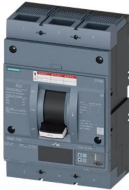
interruttore automatico 3VA6 UL frame 800 classe del potere di interruzione C 100 kA con 480 V a 3 poli, protezione impianto ETU860, LSIG, In=800 A protezione da sovraccarico Ir=315 A ... 800 A protezione da cortocircuito I<sub>sd</sub>=0,6 ... 10x I<sub>n</sub>, I<sub>i</sub>=1,5 ... 10x I<sub>n</sub> protezione del conduttore di neutro opzionale con CT est. fino a 160 % protezione da guasto verso terra I<sub>g</sub>=0,2 ... 1 x I<sub>n</sub>, t<sub>g</sub>=0,05 ... 0,8s
