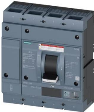
interruttore automatico 3VA6 UL frame 800 classe del potere di interruzione C 100 kA con 480 V a 4 poli, protezione impianto ETU820, LI, In=800 A protezione da sovraccarico, 100 % nominale Ir=315 A ... 800 A protezione da cortocircuito li=1,5 ... 10 x In protezione del conduttore di neutro impostabile (OFF, fino a 100 %) attacco piatto a vite
