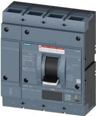
interruttore automatico 3VA6 UL frame 800 classe del potere di interruzione C 100 kA con 480 V a 4 poli, protezione impianto ETU556, LSI, In=800 A protezione da sovraccarico Ir=315 A ... 800 A protezione da cortocircuito Isd=0,6 ... 10x In, li=1,5 ... 10x In protezione del conduttore di neutro impostabile (OFF, fino al 160 %) allarme di guasto verso terra segnalazione tramite EFB300 o COM attacco piatto a vite
