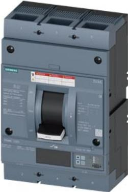
interruttore automatico 3VA6 UL frame 800 classe del potere di interruzione C 100 kA con 480 V a 3 poli, protezione impianto ETU560, LSIG, In=800 A protezione da sovraccarico Ir=315 A ... 800 A protezione da cortocircuito Isd=0,6 ... 10x In, li=1,5 ... 10x In protezione del conduttore di neutro opzionale con CT est. fino a 160 % protezione da guasto verso terra Ig=0,2 ... 1 x In, tg=0,05 ... 0,8s
