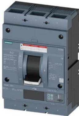
interruttore automatico 3VA6 UL frame 800 classe del potere di interruzione C 100 kA con 480 V a 3 poli, protezione impianto ETU550, LSI, In=800 A protezione da sovraccarico Ir=315 A ... 800 A protezione da cortocircuito I<sub>sd</sub>=0,6 ... 10x I<sub>n</sub>, I<sub>i</sub>=1,5 ... 10x I<sub>n</sub> protezione del conduttore di neutro opzionale con CT est. fino a 160 % attacco piatto a vite
