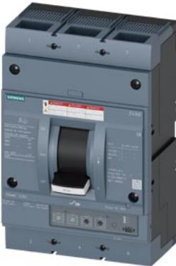
interruttore automatico 3VA6 UL frame 800 classe del potere di interruzione C 100 kA con 480 V a 3 poli, protezione impianto ETU350, LSI, In=800 A protezione da sovraccarico, 100 % nominale Ir=315 A ... 800 A protezione da cortocircuito Isd=1,5 ... 10 x Ir, li=10 x In attacco piatto a vite
