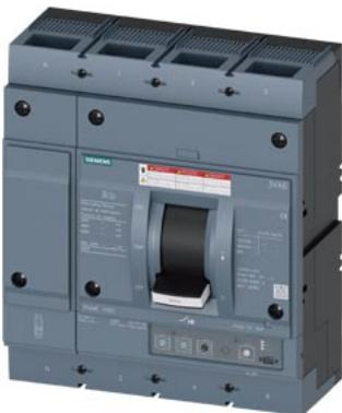
interruttore automatico 3VA6 UL frame 800 classe del potere di interruzione C 100 kA con 480 V a 4 poli, protezione impianto ETU320, LI, In=800 A protezione da sovraccarico, 100 % nominale Ir=315 A ... 800 A protezione da cortocircuito Ii=1,5 ... 10 x In protezione del conduttore di neutro impostabile (OFF, 50 %, 100 %) attacco piatto a vite
