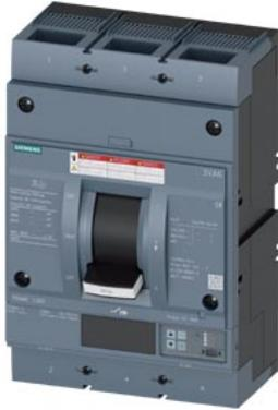
interruttore automatico 3VA6 UL frame 800 classe del potere di interruzione H 65 kA con 480 V a 3 poli, protezione impianto ETU820, LI, In=800 A protezione da sovraccarico, 100 % nominale Ir=315 A ... 800 A protezione da cortocircuito li=1,5 ... 10 x In attacco piatto a vite
