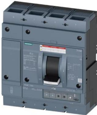
interruttore automatico 3VA6 UL frame 800 classe del potere di interruzione H 65 kA con 480 V a 4 poli, protezione impianto ETU350, LSI, In=800 A protezione da sovraccarico, 100 % nominale Ir=315 A ... 800 A protezione da cortocircuito I<sub>sd</sub>=1,5 ... 10 x I<sub>r</sub>, I<sub>i</sub>=10 x I<sub>n</sub> protezione del conduttore di neutro impostabile (OFF, 50 %, 100 %) attacco piatto a vite
