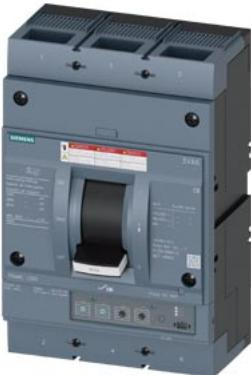
interruttore automatico 3VA6 UL frame 800 classe del potere di interruzione H 65 kA con 480 V a 3 poli, protezione impianto ETU330, LIG, In=800 A protezione da sovraccarico Ir=315 A ... 800 A protezione da cortocircuito Ii=1,5 ... 10 x In protezione da guasto verso terra Ig=0,2 ... 1 x In, tg=0,1/0,3s attacco piatto a vite
