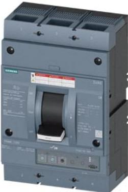
interruttore automatico 3VA6 UL frame 800 classe del potere di interruzione H 65 kA con 480 V a 3 poli, protezione impianto ETU320, LI, In=800 A protezione da sovraccarico, 100 % nominale Ir=315 A ... 800 A protezione da cortocircuito Ii=1,5 ... 10 x In attacco piatto a vite
