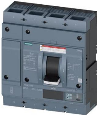
interruttore automatico 3VA6 UL frame 800 classe del potere di interruzione M 35 kA con 480 V a 4 poli, protezione impianto ETU560, LSIG,  $I_n=800$  A protezione da sovraccarico  $I_r=315$  A ... 800 A protezione da cortocircuito  $I_{sd}=0,6$  ...  $10 \times I_n$ ,  $I_i=1,5$  ...  $10 \times I_n$  protezione del conduttore di neutro impostabile (OFF, fino al 160 %) protezione da guasto verso terra  $I_g=0,2$  ...  $1 \times I_n$ ,  $t_g=0,05$  ... 0,8s attacco piatto a vite
