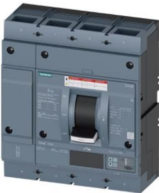
interruttore automatico 3VA6 UL frame 800 classe del potere di interruzione M 35 kA con 480 V a 4 poli, protezione impianto ETU550, LSI, In=800 A protezione da sovraccarico, 100 % nominale Ir=315 A ... 800 A protezione da cortocircuito Isd=0,6 ... 10x In, li=1,5 ... 10x In protezione del conduttore di neutro impostabile (OFF, fino al 160 %) attacco piatto a vite
