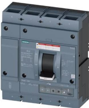
interruttore automatico 3VA6 UL frame 800 classe del potere di interruzione M 35 kA con 480 V a 4 poli, protezione impianto ETU350, LSI, In=800 A protezione da sovraccarico Ir=315 A ... 800 A protezione da cortocircuito lsd=1,5 ... 10 x Ir, li=10 x In protezione del conduttore di neutro impostabile (OFF, 50 %, 100 %) attacco piatto a vite
