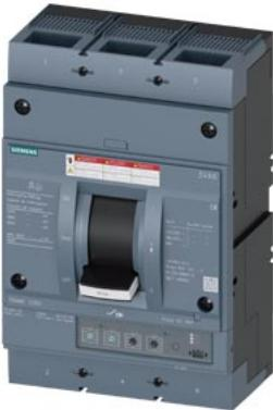
interruttore automatico 3VA6 UL frame 800 classe del potere di interruzione M 35 kA con 480 V a 3 poli, protezione impianto ETU350, LSI, In=800 A protezione da sovraccarico, 100 % nominale Ir=315 A ... 800 A protezione da cortocircuito Isd=1,5 ... 10 x Ir, li=10 x In attacco piatto a vite
