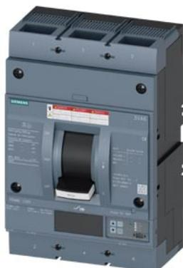
interruttore automatico 3VA6 UL frame 800 classe del potere di interruzione C 100 kA con 480 V a 3 poli, protezione impianto ETU860, LSIG,  $I_n=600$  A protezione da sovraccarico, 100 % nominale  $I_r=240$  A ... 600 A protezione da cortocircuito  $I_{sd}=0,6 \dots 12x I_n$ ,  $I_i=1,5 \dots 12x I_n$  protezione del conduttore di neutro opzionale con CT est. fino a 160 % protezione da guasto verso terra  $I_g=0,2 \dots 1 x I_n$ ,  $t_g=0,05 \dots 0,8s$
