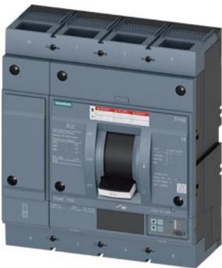
interruttore automatico 3VA6 UL Frame 800 classe del potere di interruzione C 100 kA con 480 V a 4 poli, protezione impianto ETU820, LI, In=600 A, protezione da sovraccarico Ir=240 A ... 600 A protezione da cortocircuito Ii=1,5 ... 10 x In protezione del conduttore di neutro impostabile (OFF, fino a 130%) attacchi piatti a vite
