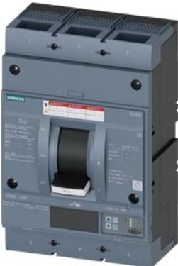
interruttore automatico 3VA6 UL frame 800 classe del potere di interruzione C 100 kA con 480 V a 3 poli, protezione impianto ETU556, LSI, In=600 A protezione da sovraccarico, 100 % nominale Ir=240 A ... 600 A protezione da cortocircuito Isd=0,6 ... 12x In, li=1,5..12x In protezione del conduttore di neutro opzionale con CT est. fino a 160 % allarme di guasto verso terra segnalazione tramite EFB300 o COM
