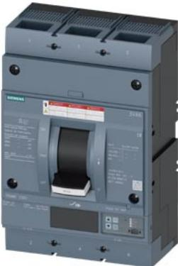
interruttore automatico 3VA6 UL Frame 800 classe del potere di interruzione C 100 kA con 480 V a 3 poli, protezione impianto ETU550, LSI, In=600 A, protezione da sovraccarico Ir=240 A ... 600 A protezione da cortocircuito lsd=0,6 ... 12x In, li=1,5 ... 12 x In protezione del conduttore di neutro opzionale con CT est. fino a 160% attacchi piatti a vite
