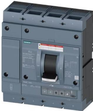
interruttore automatico 3VA6 UL frame 800 classe del potere di interruzione C 100 kA con 480 V a 4 poli, protezione impianto ETU330, LIG,  $I_n=600$  A protezione da sovraccarico, 100 % nominale  $I_r=240$  A ... 600 A protezione da cortocircuito  $i=1,5$  ...  $12 \times I_n$  protezione del conduttore di neutro regolabile (OFF, 50 %, 100 %) protezione da guasto verso terra  $I_g=0,2$  ...  $1 \times I_n$ ,  $t_g=0,1/0,3s$  attacchi piatti a vite
