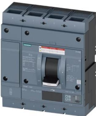
interruttore automatico 3VA6 UL frame 800 classe del potere di interruzione H 65 kA con 480 V a 4 poli, protezione impianto ETU820, LI, In=600 A protezione da sovraccarico, 100 % nominale Ir=240 A ... 600 A protezione da cortocircuito Ii=1,5 ... 10 x In protezione del conduttore di neutro regolabile (OFF, fino a 130 %) attacchi piatti a vite
