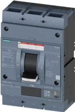
interruttore automatico 3VA6 UL frame 800 classe del potere di interruzione M 35 kA con 480 V a 3 poli, protezione impianto ETU856, LSI, In=600 A protezione da sovraccarico, 100 % nominale Ir=240 A ... 600 A protezione da cortocircuito Isd=0,6 ... 12x In, li=1,5..12x In protezione del conduttore di neutro opzionale con CT est. fino a 160 % allarme di guasto verso terra segnalazione tramite EFB300 o COM
