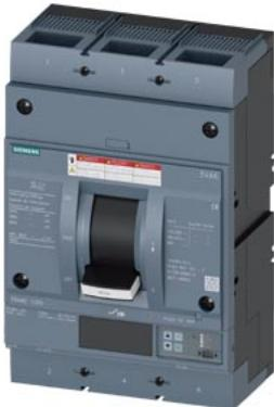
interruttore automatico 3VA6 UL Frame 800 classe del potere di interruzione M 35 kA con 480 V a 3 poli, protezione impianto ETU860, LSIG, In=600 A, protezione da sovraccarico Ir=240 A ... 600 A protezione da cortocircuito Isd=0,6 ... 12x In, li=1,5 ... 12 x In protezione del conduttore di neutro opzionale con CT est. fino a 160% protezione da guasto verso terra Ig=0,2 ... 1 x In, tg=0,05 ... 0,8s
