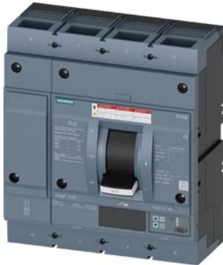
interruttore automatico 3VA6 UL Frame 800 classe del potere di interruzione M 35 kA con 480 V a 4 poli, protezione impianto ETU820, LI, In=600 A, protezione da sovraccarico Ir=240 A ... 600 A protezione da cortocircuito Ii=1,5 ... 10 x In protezione del conduttore di neutro impostabile (OFF, fino a 130%) attacchi piatti a vite
