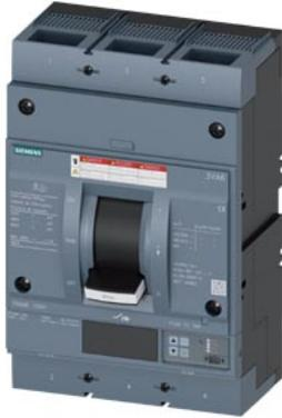
interruttore automatico 3VA6 UL frame 800 classe del potere di interruzione M 35 kA con 480 V a 3 poli, protezione impianto ETU560, LSIG,  $I_n=600$  A protezione da sovraccarico, 100 % nominale  $I_r=240$  A ... 600 A protezione da cortocircuito  $I_{sd}=0,6 \dots 12x I_n$ ,  $I_i=1,5 \dots 12x I_n$  protezione del conduttore di neutro opzionale con CT est. fino a 160 % protezione da guasto verso terra  $I_g=0,2 \dots 1 x I_n$ ,  $t_g=0,05 \dots 0,8$ s
